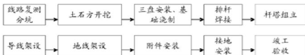
图 2-6 电力工程施工流程及产污节点图
