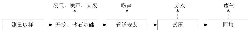
图 2-2 管线施工工艺
