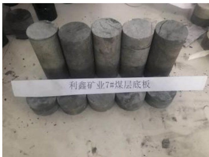
(3) 底板岩样 图 3-1 试件加工
