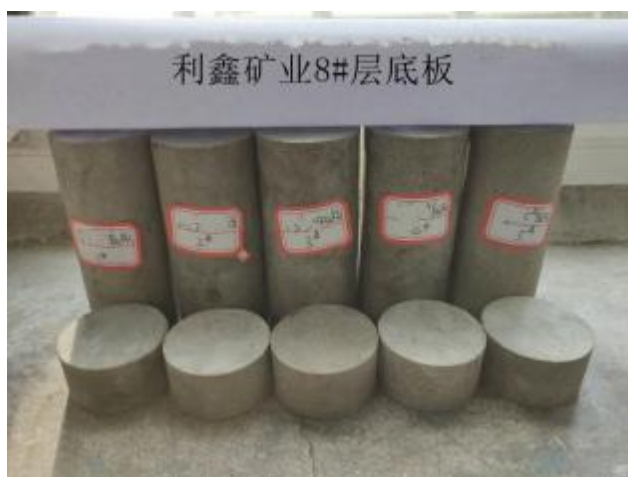
(3) 底板岩样 图 3-1 试件加工
