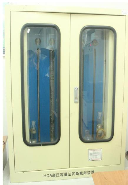
图 3-1 HCA 高压容量法瓦斯吸附装置
